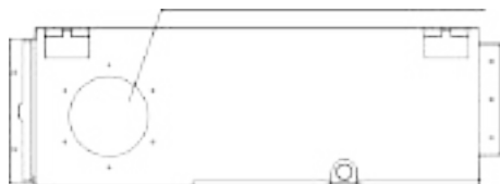
Junta de conduta de ar novo
