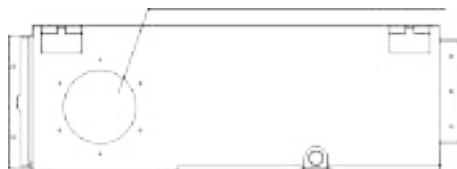
Kanalverbindung für Frischluft
